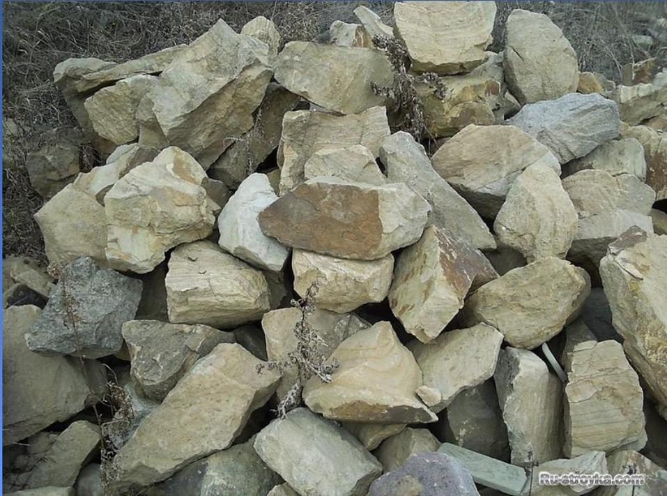
Природными каменными материалами называют строительные материалы и изделия, получаемые из горных пород методами механической обработки (дроблением, раскалыванием, распиливанием).
