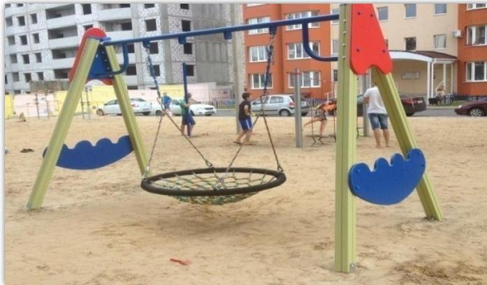
Ударопоглощающее покрытие из песка, разрешенный размер частиц от 0,2 до 2, минимальная толщина 200 мм
