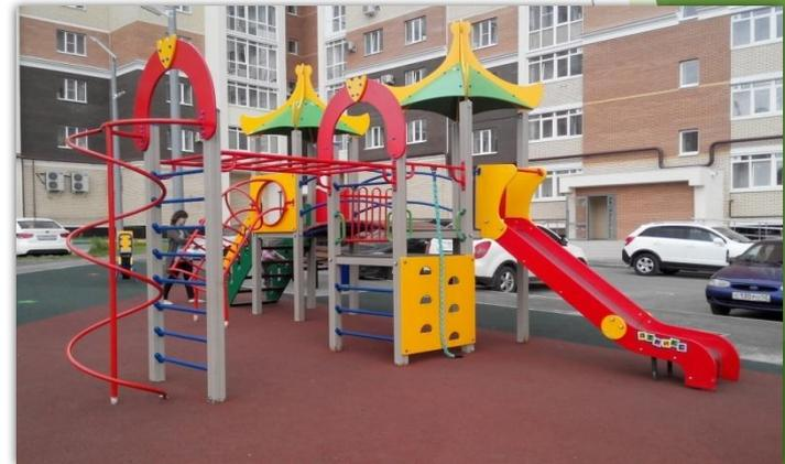
Ударопоглощающее покрытие из гранулированной резиновой крошки, толщина от 10 мм до 50 мм
