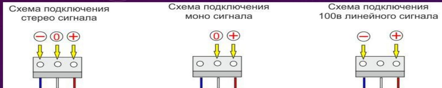
**Откройте корпус VERT-135 и закрепите его на стене на удалении 100 мм от других предметов. Подключите индукционный контур и линейные источники звука ко входам индукционной системы в соответствии со схемой и сделайте необходимые настройки, указанные в паспорте системы.**
