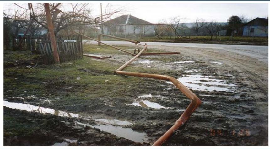
Разрыв газопровода ОАО «Юггазсервис» в г. Новороссийске
