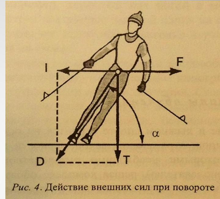
Рис. 4. Действие внешних сил при повороте
