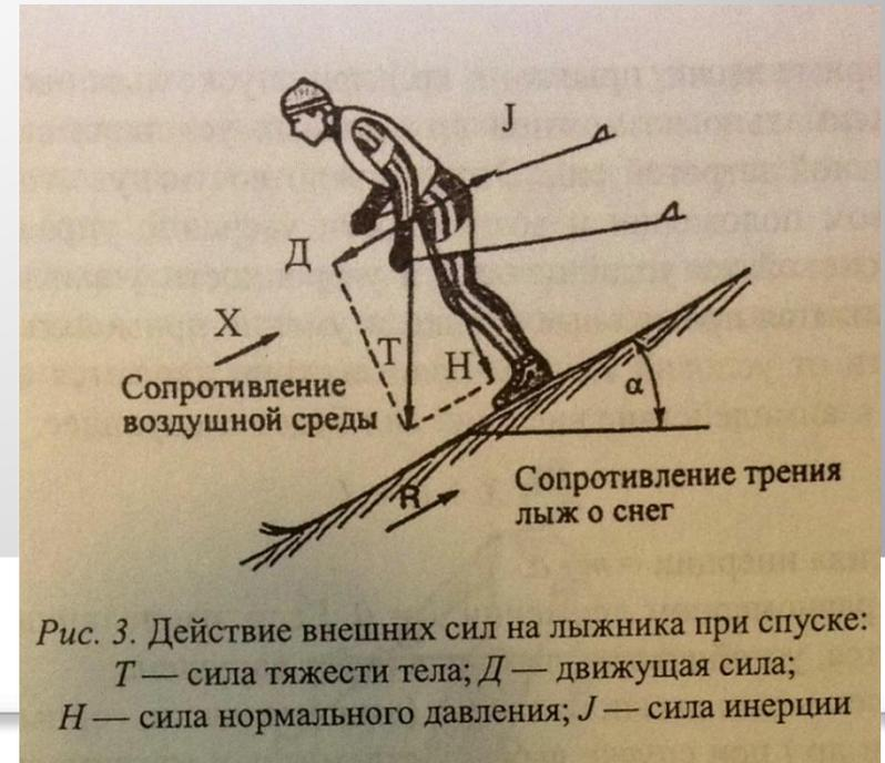
Рис. 3. Действие внешних сил на лыжника при спуске:
