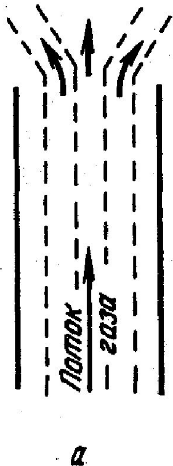
Рис. 3.1. Отбор пробы газа в потоке: а — метод продольных струй; б — метод поперечных сечений (стрелками показаны места отбора проб)
