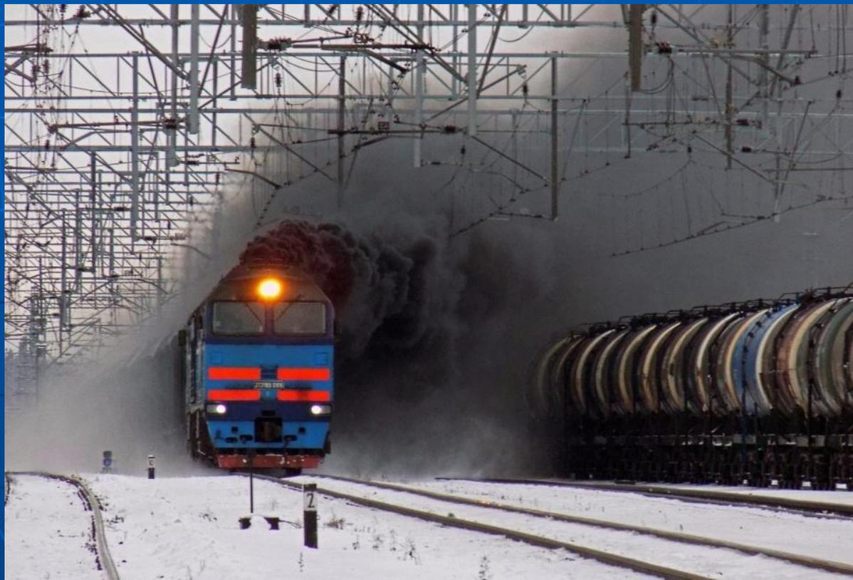
Основная опасность железнодорожного транспорта – течь смазочных материалов из механизмов локомотивов и вагонов. Они сильно загрязняют полотно пути и почву под ними, причем загрязнение является не только поверхностным, но и глубинным, поскольку смазка просачивается вглубь земли. Так же важна проблема загрязнения экологии из-за выброса в атмосферу продуктов сгорания топлива.
