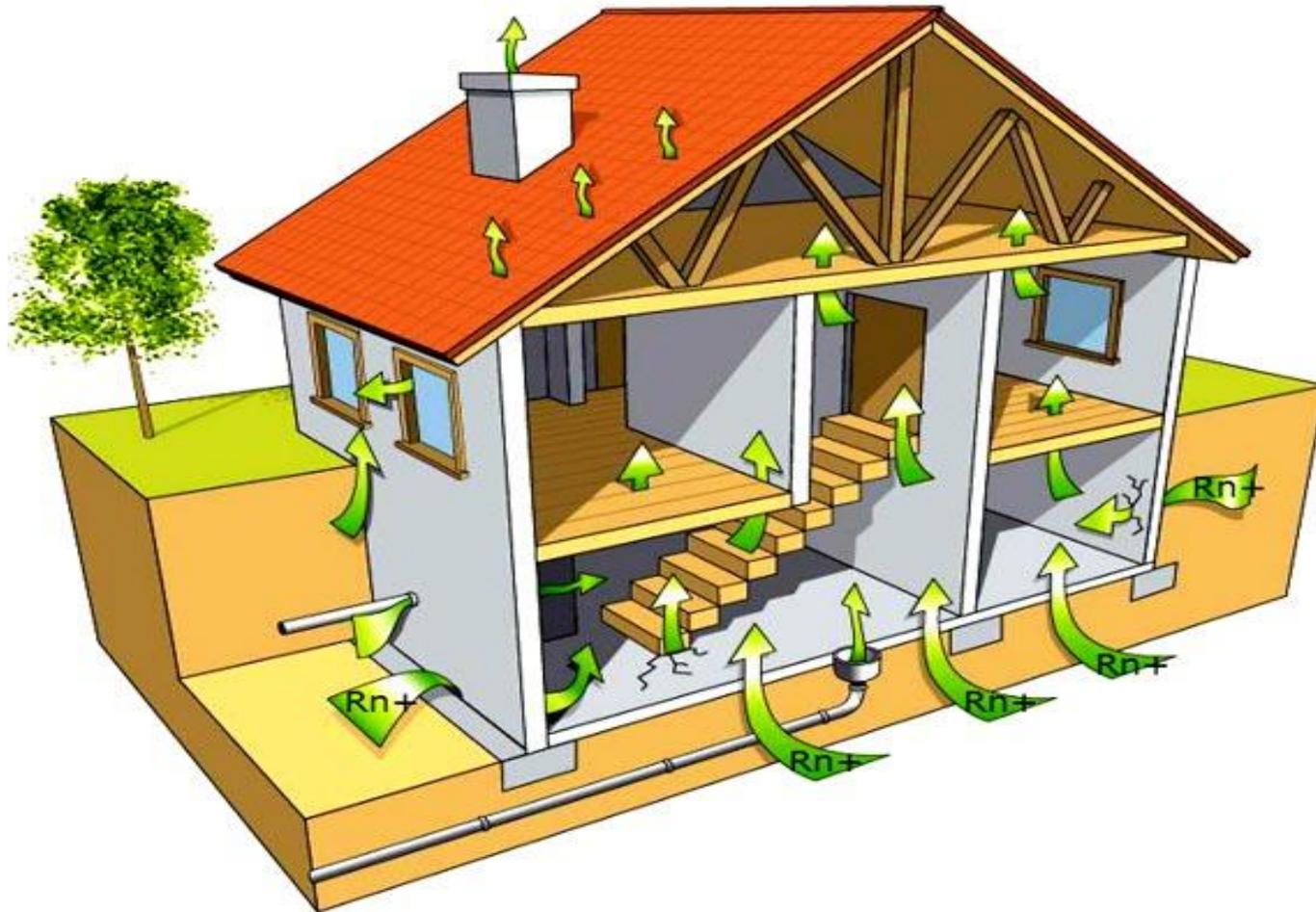
Основные источники радона в помещениях: трещины в плитах фундамента, поры в кирпичных стенах, трещины в строительных блоках, неполная изоляция грунта, дренажная плитка, плохое цементирование блоков, плохая герметизация труб, открытый верх фундамента, строительные материалы, вода.
