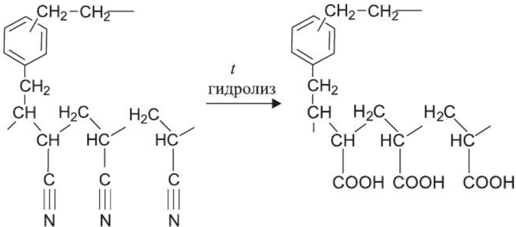
Рис. 4. Схема щелочного гидролиза пористого сополимера акрилонитрила с дивинилбензолом
