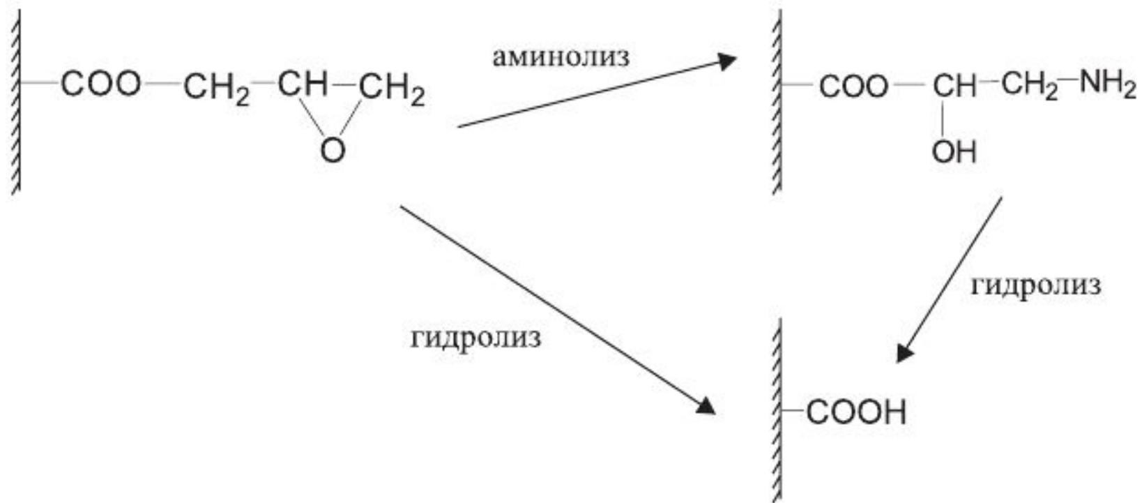
Рис. 3. Схема щелочного гидролиза пористого сополимера глицидилметакрилата с этиленгликоль-диметакрилатом
