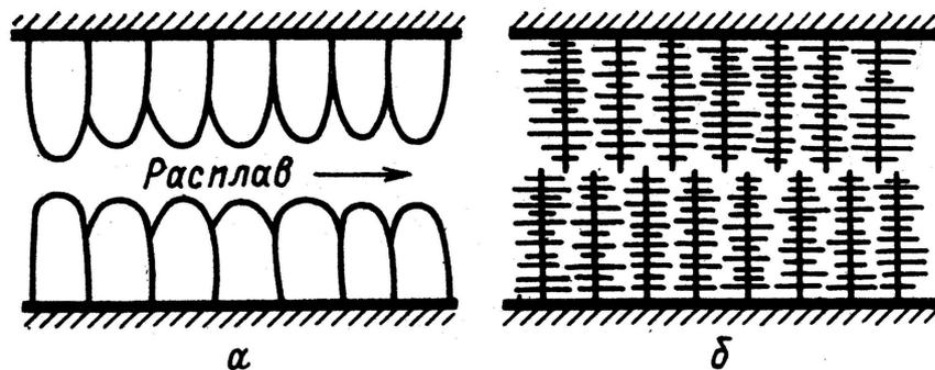
Склонность к образованию горячих трещин
