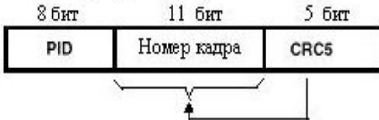
Рис. 4-6 Структура маркерного пакета типа SOF
