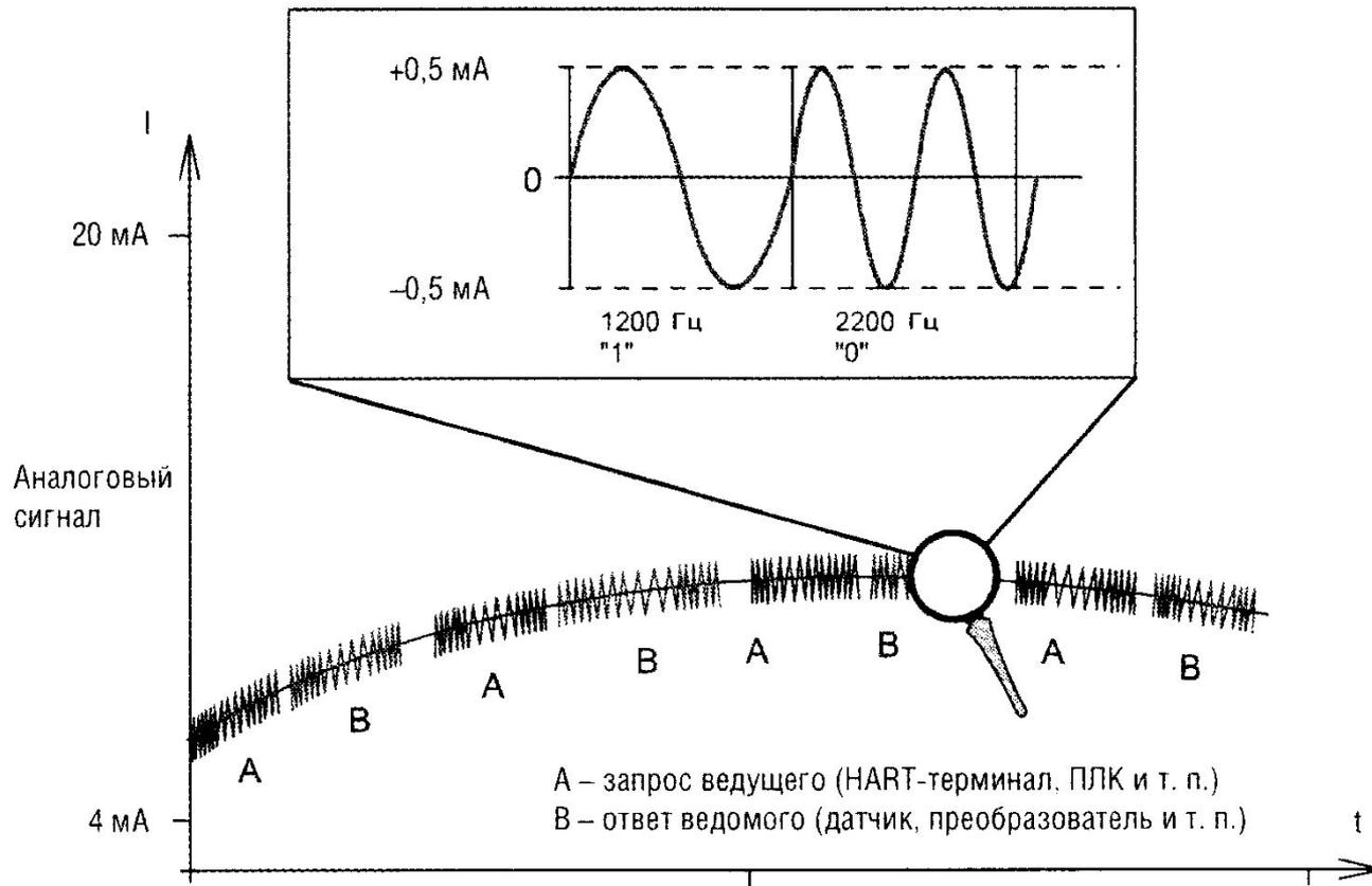
Рис. 3. Кодирование HART-сигнала
