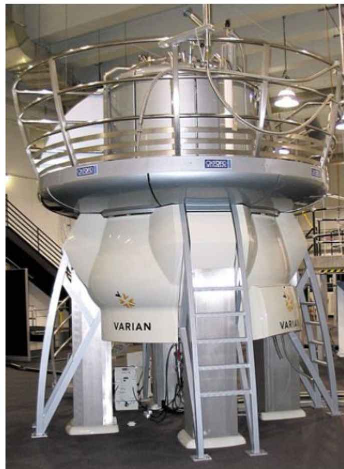
Магнит спектрометра Varian 900 МГц
