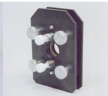
Приставка для измерения пропускания пластин
