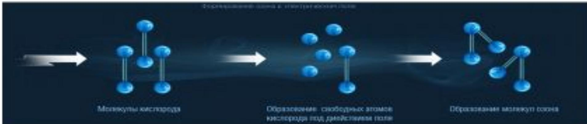
Озон образуется из кислорода под воздействием ультрафиолетового излучения.
