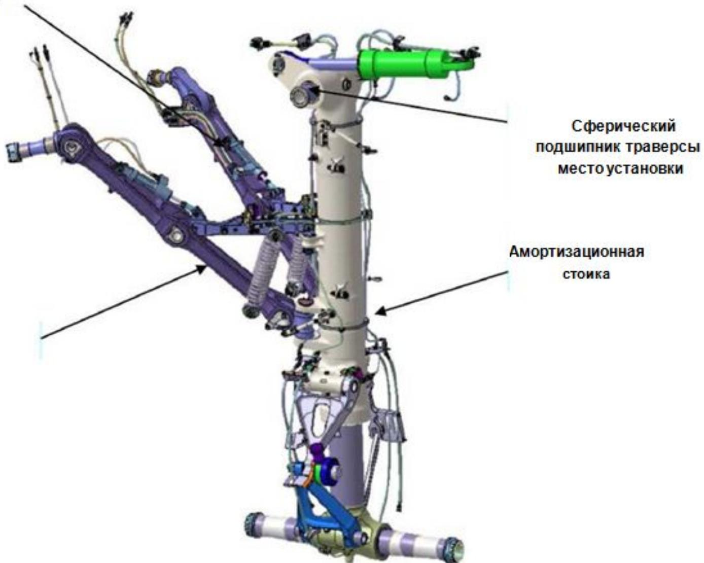
Структурная схема основной опоры шасси
