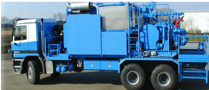
**Двухнасосная установка** смонтирована на шасси автомобиля Мерседес Бенц. Два верхних двигателя Детройт Дизель по 350л.с.каждый, снабжены автоматическими трансмиссиями «Аллисон», позволяющими плавно регулировать производительность. Трехплунжерный насос NT-400 развивает макс. рабочее давление до 785 атм. Установка имеет два мерных бака ёмкостью по 1,50 м<sup>3</sup>, для проведения продавки с тарировкой по 100л.
