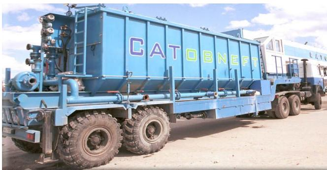
**Установка для приготовления цементного, буферного, гелеобразующего растворов** позволяет качественно приготовить от 0,5 до 27м<sup>3</sup> тампонажного материала. Разделенные емкости имеют массивные мешалки, оснащенные гидравлическим или электрическим приводом. Миксер оборудован двумя центробежными насосами и двумя насосами высокого давления для подачи жидких хим.реагентов.
