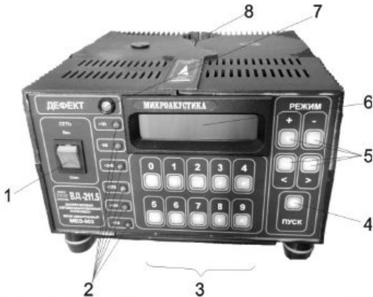
1 — тумблер **СЕТЬ**; 2 — светодиодные индикаторы напряжения питания электронного блока; 3 — кнопки цифровой клавиатуры; 4 — кнопка **ПУСК**, 5 — кнопки переключения режимов (состояний) дефектоскопа; 6 — дисплей; 7 — индикатор **ДЕФЕКТ**; 8 — аккумуляторная батарея.
