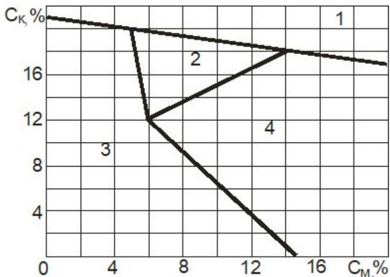
Рисунок 1. Объемные пределы взрываемости метано-воздушных смесей
