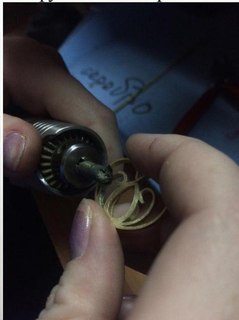
**Фактурирование** – это процесс нанесения шероховатости на поверхность ювелирного изделия, значительно отличающаяся от полированной, приятной на вид и несущая декоративную нагрузку
