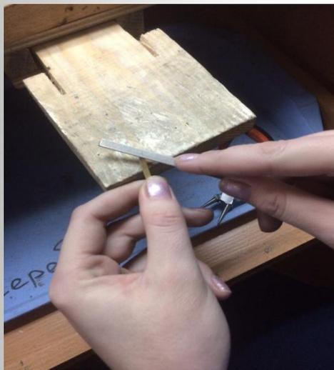
**Разметка** – это процесс переноса рисунка и его размеров на заготовку
