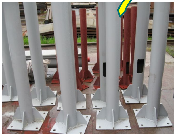
Металлические опоры освещения
