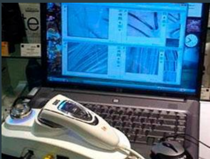
Диагностическая трихологическая камера серии ARAMO SG с программным обеспечением для фиксирования и обработки снимков
