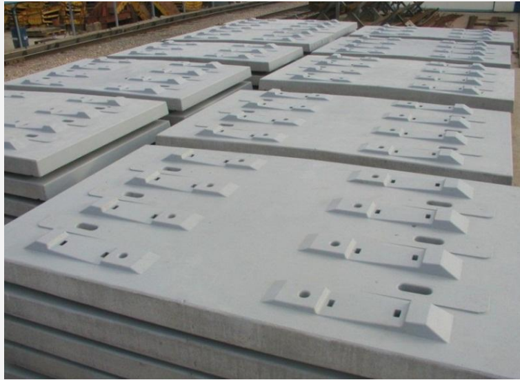
Рисунок 14 – Плиты безбалластного мостового полотна
