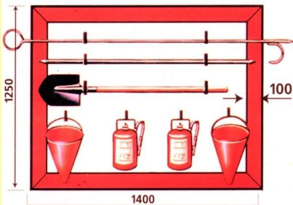
Предназначен для размещения первичных средств пожаротушения, инструмента и пожарного инвентаря в производственных, складских помещениях, необорудованных противопожарным водопроводом и автоматическими установками пожаротушения, а также на территории предприятий, не имеющих наружного противопожарного водопровода, комплектуется согласно ППБ 01-93 \*\*.
