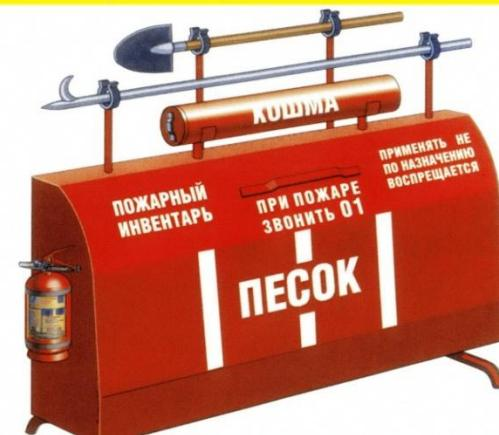
Предназначены для размещения и хранения огнетушителей пожарного инструмента и инвентаря, применяемых для ликвидации пожаров в организациях, на объектах экономики, в складских помещениях и заправочных пунктах - устанавливаются как правило на улице.
