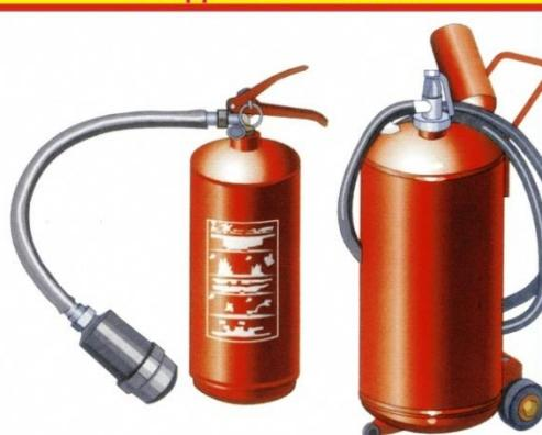
Применяется при загораниях различных веществ и материалов при температуре окружающей среды от +5 до +50 град., за исключением щелочных, щелочноземельных элементов и электроустановок под напряжением. Зимой хранить в отапливаемом помещении!
