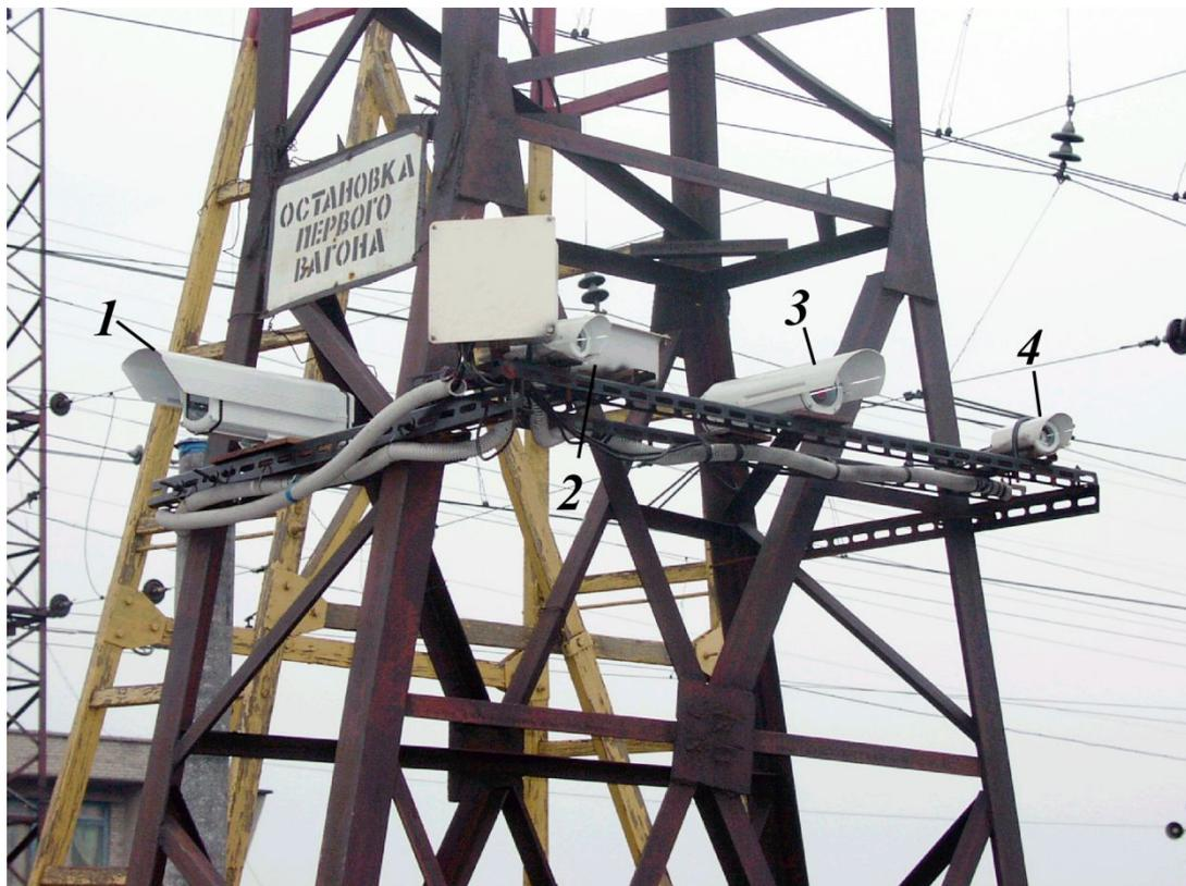
1 – видеокамера обзора, запуска и выключения системы; 2,4 – блоки лазерных маркеров; 3 – видеокамера контроля колебаний кузова вагона.
