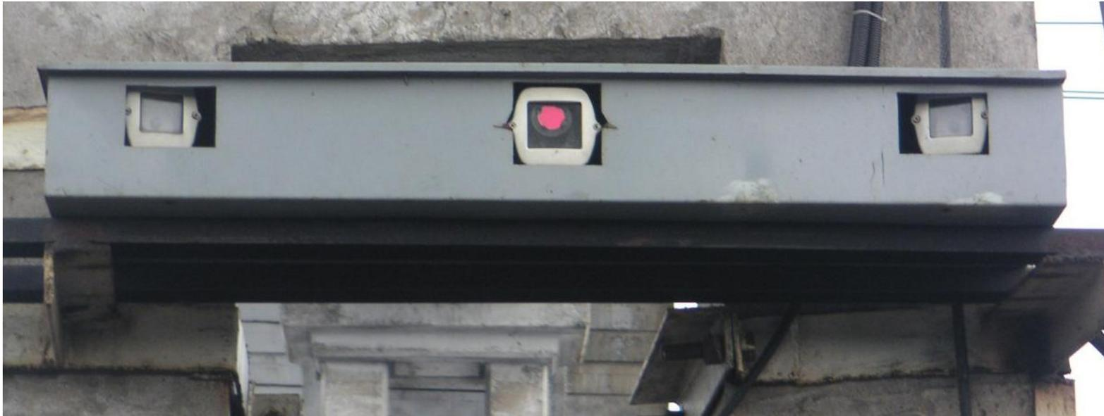
Видеокамеры и датчики монтируются в термостатических боксах, обеспечивающих стабильную работу устройств при пониженных температурах окружающей среды.
