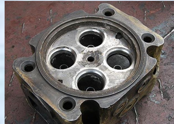
Седло головки цилиндров после восстановления.
