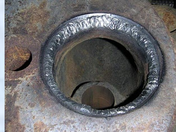
Седло головки цилиндров после восстановления.
