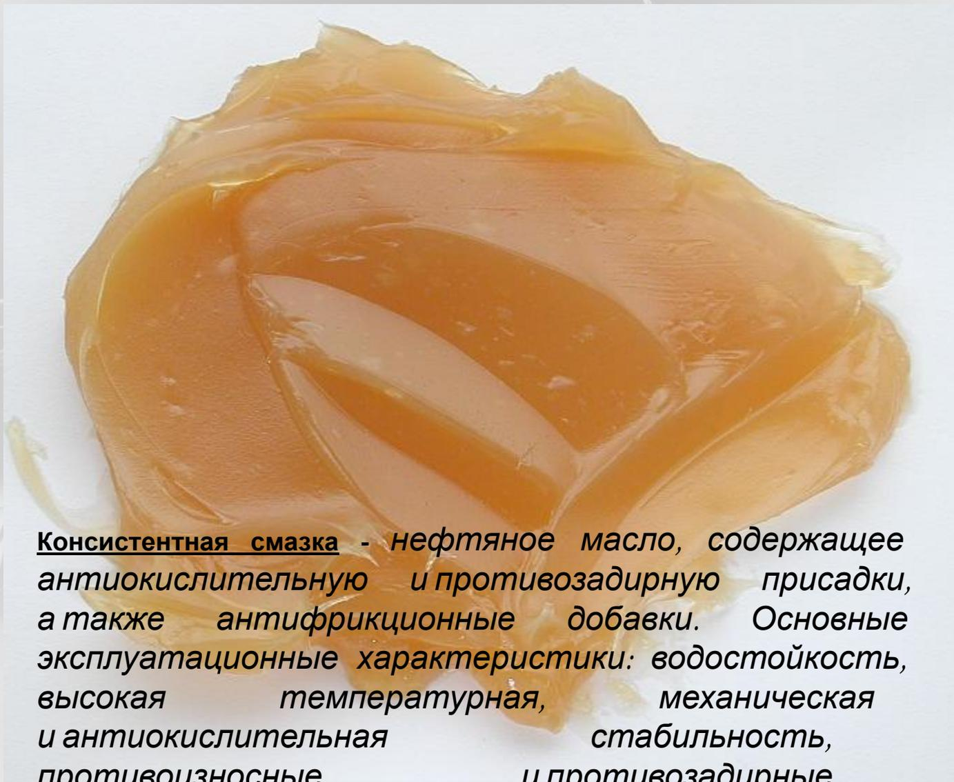
Консистентная смазка - нефтяное масло, содержащее антиокислительную и противозадирную присадки, а также антифрикционные добавки. Основные эксплуатационные характеристики: водостойкость, высокая температурная, механическая и антиокислительная стабильность, противоизносные и противозадирные характеристики, низкая испаряемость.
