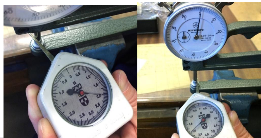
Рисунок 4 - Измерение показаний толщиномера при нажиме на измерительный стержень с помощью граммометра часового типа
