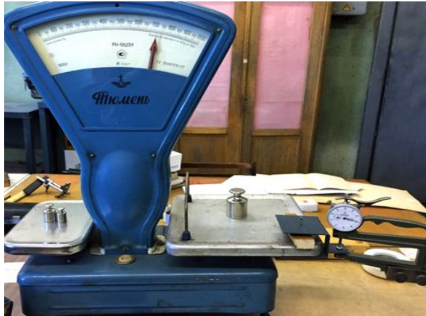
Рисунок 5 - Определение измерительного усилия и его колебания с помощью циферблатных весов и специального приспособления
