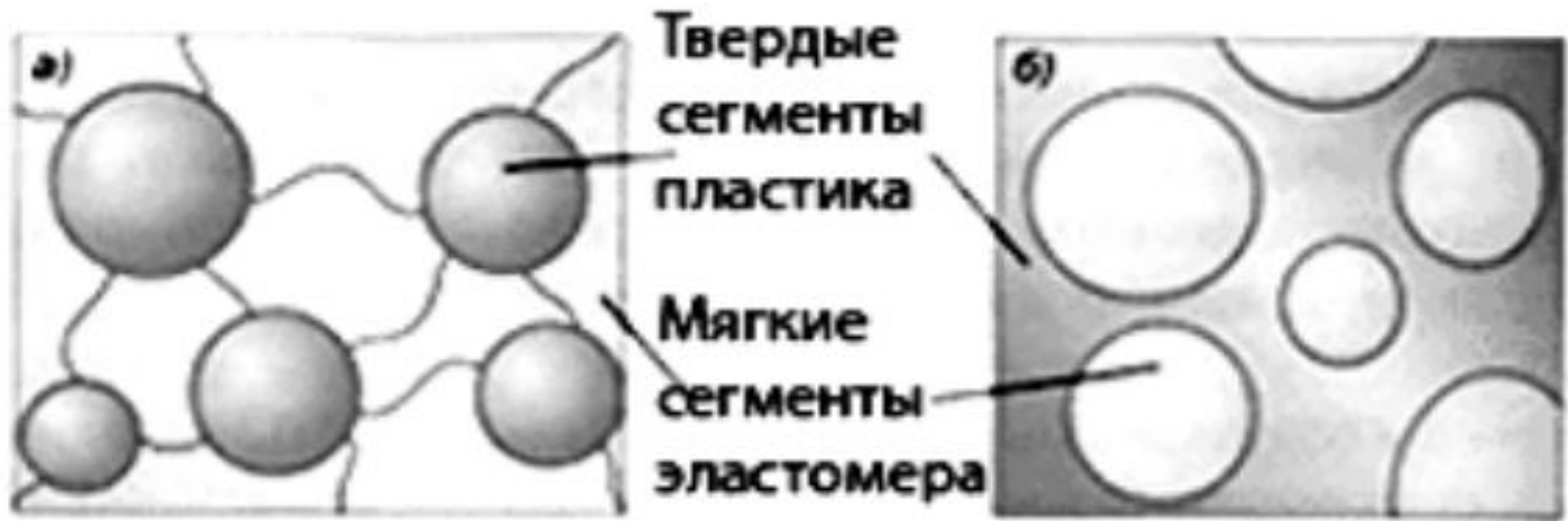
Схема молекулярной структуры реакторных и смесевых ТПЭ а) реакторные, б) смесевые
