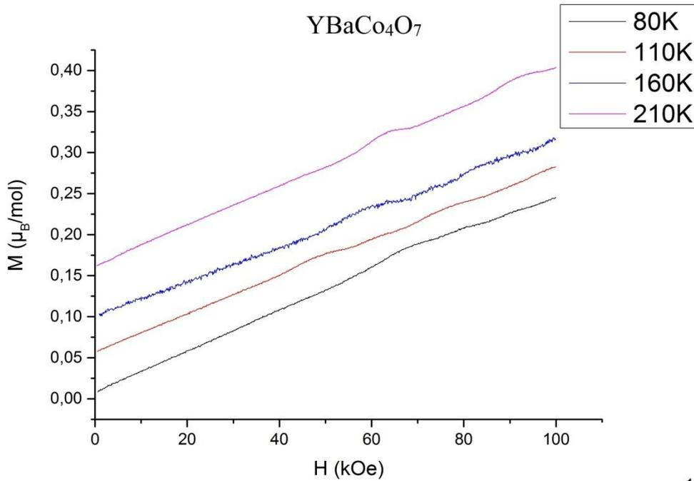
Кривые намагничивания  $\text{YBaCo}_4\text{O}_7$  при различных температурах (вклад кобальтовой подрешетки)
