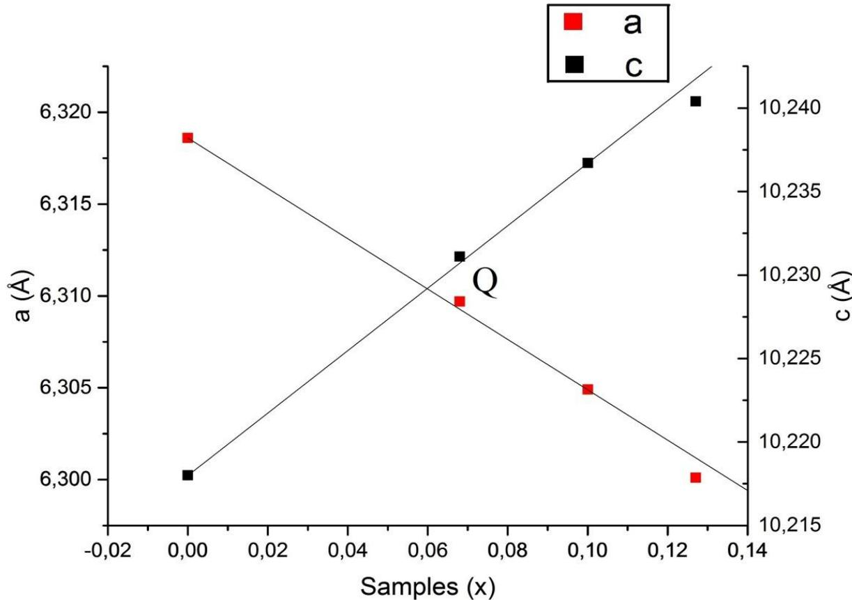
*Размеры  $a_{avr}$  и c кристаллической решетки для образцов  $DyBaCo_4O_{7+x}$  с разными отклонениями от стехиометрии  $x = 0.1, 0.0, 0.2, 1.4$  и для закаленного образца Q*
