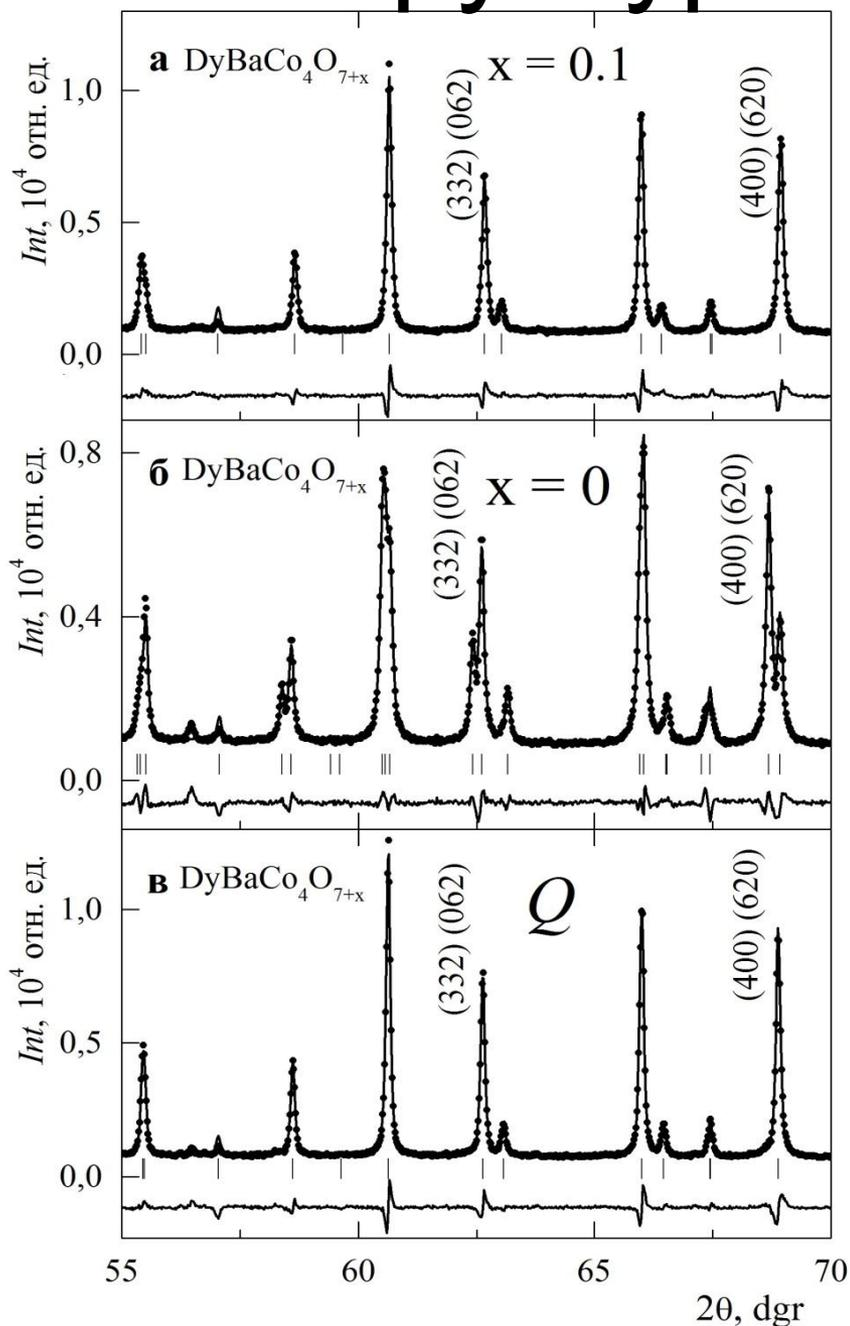
Экспериментальные (точки) и рассчитанные (линии) рентгенограммы и разность между ними (линии внизу) для образцов  $\text{DyBaCo}_4\text{O}_{7+x}$  с разными отклонениями от стехиометрии  $x = 0.1, 0$  и для закаленного образца  $Q$  на  $\text{CoK}_{\alpha 1}$ -излучении.
