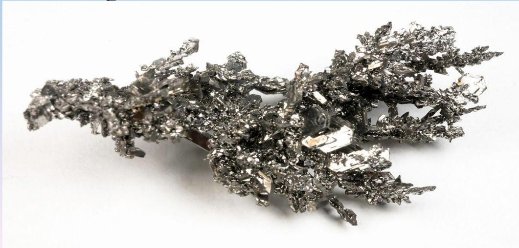
Производство титана является технически сложным процессом. Двоокись титана  $\text{TiO}_2$  — химически прочное соединение. Металлический титан ( $t_{\text{пл}} = 1725 \text{ }^\circ\text{C}$ ), обладает большой активностью. Наиболее широкое распространение получил магниетермический способ, осуществляемый по следующей технологической схеме: титановая руда → обогащение → плавка на титановый шлак → получение четыреххлористого титана  $\text{TiCl}_4$  → восстановление титана магнием.
