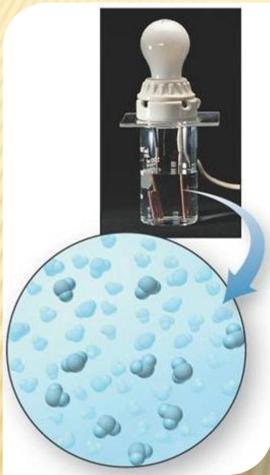
**Дистиллированная вода,** которая имеет молекулярную структуру, является **хорошим изолятором (неэлектролитом)**, т.к. в ней нет свободных электрических зарядов, а следовательно, в ней не может возникнуть электрический ток. Если собрать цепь, изображенную на рисунке, и налить в сосуд дистиллированную воду, то лампочка гореть не будет, а амперметр покажет отсутствие электрического тока в цепи.
