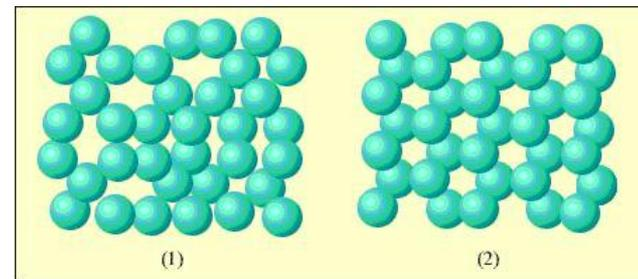
Пример ближнего порядка молекул жидкости и дальнего порядка молекул кристаллического вещества: (1) –жидкая вода; (2) – лёд (твердое тело)
