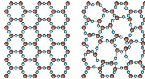
На левом рисунке изображено расположение частиц в кристаллическом кварце ( $\text{SiO}_2$ ), а на правом – в аморфном кварце ( $\text{SiO}_2$ ).
