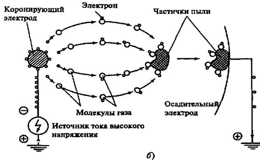
Процесс ионизации (а) и принцип работы электрофилтра (б)
