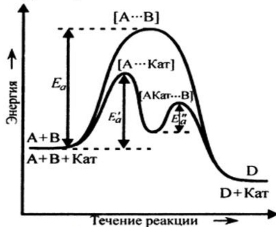
Рис. 6 Энергетический профиль реакции без катализатора и с катализатором
