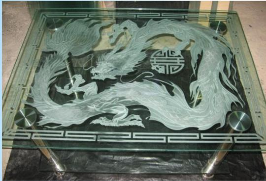
Пескоструйная обработка - холодная абразивная обработка поверхности и стекла, путем повреждения её поверхности песком или иным абразивным порошком, распыляемым потоком воздуха, а при гидроабразивной обработке – струёй воды или иной жидкости.
