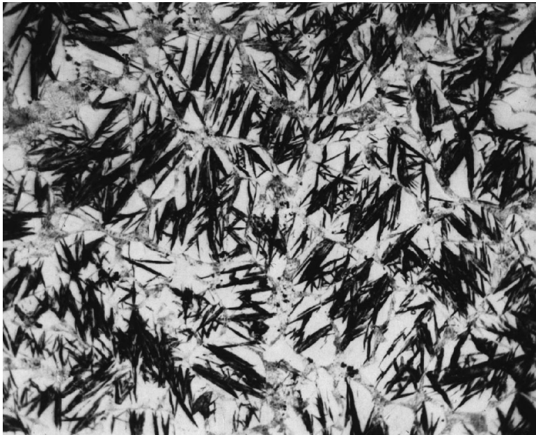
Микроструктура стали 45 после закалки
