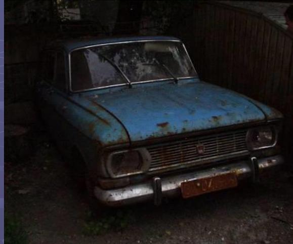
Ржавлением называют только коррозию железа и его сплавов. Другие металлы корродируют, но не ржавеют. Хотя корродируют практически все металлы, в повседневной жизни человек чаще всего сталкивается с коррозией железа.
