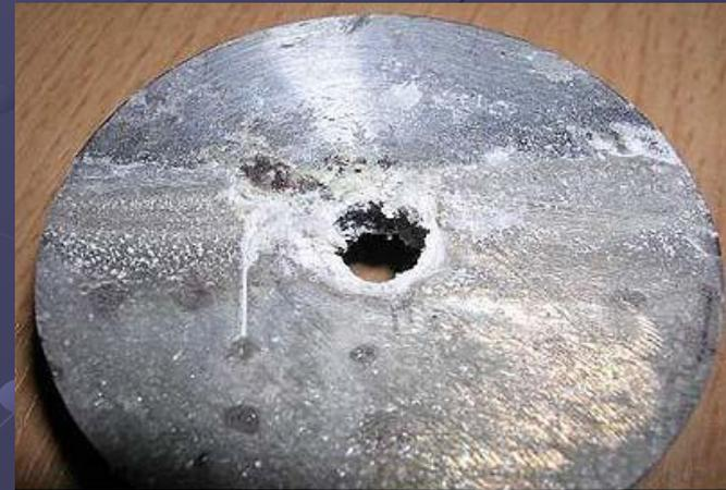
Продукты коррозии могут образовывать на поверхности металла плотный защитный слой, затормаживающий её дальнейшее развитие, или же пористый слой, не защищающий поверхность от разрушающего воздействия среды. В этом случае процесс коррозии продолжается до полного разрушения материала или период времени пока будет действовать агрессивная среда.
