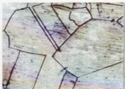
Структура деформированной бронзы с 5 % Sn после рекристаллизации
