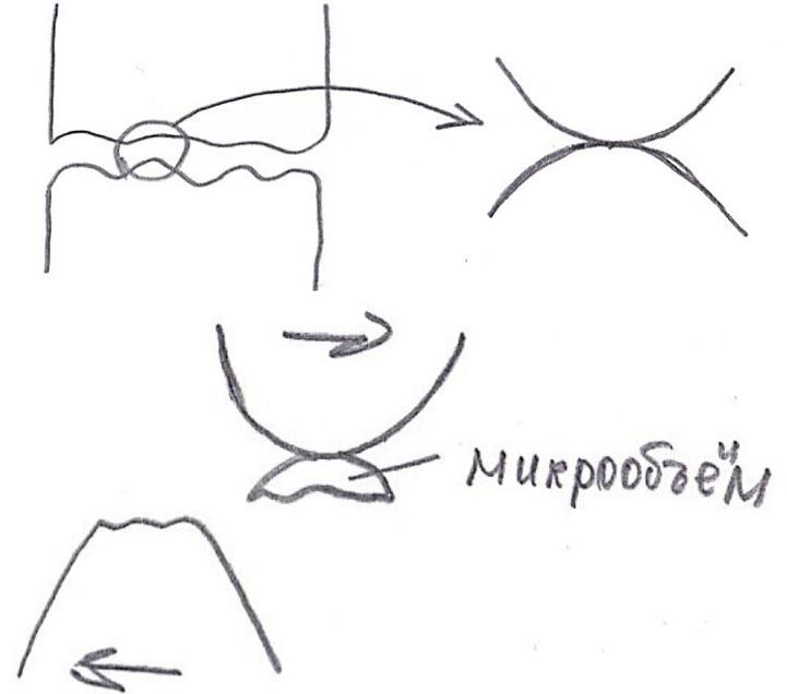
схватывание чистых, т.е. ювенильных (нет оксидной плёнки) поверхностей и вырывание значительных микрообъёмов менее прочного металла □
