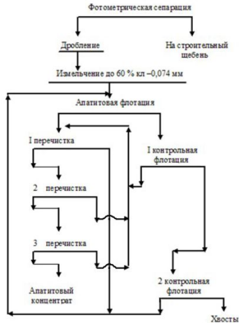
Схема обогащения руды с предварительной фотометрической сепарацией
