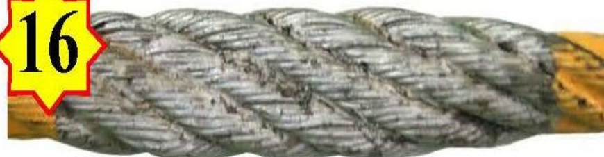
Рисунок 16 Местное увеличение диаметра каната
