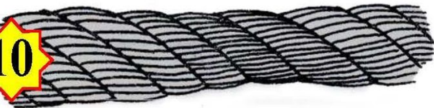
Рисунок 10 Местное уменьшение диаметра каната в результате поверхностного износа или коррозии
