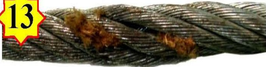
Рисунок 13 Выдавливание сердечника
