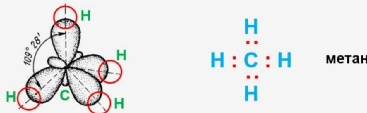
Если наибольшее перекрывание электронных облаков находится на прямой, соединяющей центры близлежащих ядер атомов, то связь называется сигма  $\sigma$ . Это ковалентная связь прочная.
