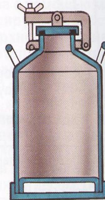
● При вскрытии барабана зубилом вырубку начинают со стороны, обратной продольному шву барабана. Зубило и молоток должны быть из материалов, не образующих искр
