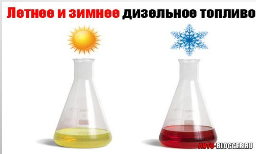
**ЛЕТНЕЕ ДИЗЕЛЬНОЕ ТОПЛИВО:** ПЛОТНОСТЬ: НЕ БОЛЕЕ 860 КГ/М<sup>3</sup>. ТЕМПЕРАТУРА ВСПЫШКИ: 62 °С. ТЕМПЕРАТУРА ЗАСТЫВАНИЯ: -5 °С. ПОЛУЧАЕТСЯ СМЕШЕНИЕМ ПРЯМОГОННЫХ, ГИДРООЧИЩЕННЫХ И ВТОРИЧНОГО ПРОИСХОЖДЕНИЯ УГЛЕВОДОРОДНЫХ ФРАКЦИЙ С ТЕМПЕРАТУРОЙ ВЫКИПАНИЯ 180—360 °С. РОСТ ТЕМПЕРАТУРЫ КОНЦА ВЫКИПАНИЯ ПРИВОДИТ К УСИЛЕННОМУ ЗАКОКСОВЫВАНИЮ ФОРСУНОК И ДЫМНОСТИ.
