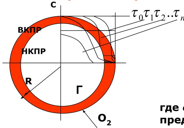
**Первая стадия** горения протекает при коэффициенте расхода воздуха соответствующем предельно богатой газо-воздушной смеси:
