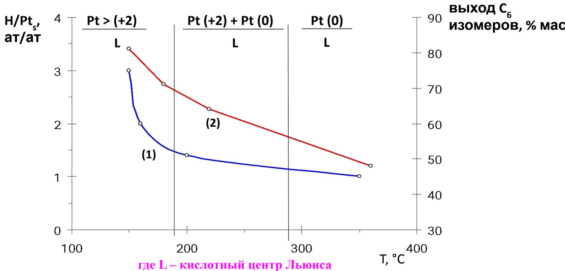
Количество адсорбированного водорода на Pt (1) и выход изомеров C<sub>6</sub> (2) в температурном диапазоне активности бифункциональных катализаторов скелетной изомеризации алканов
