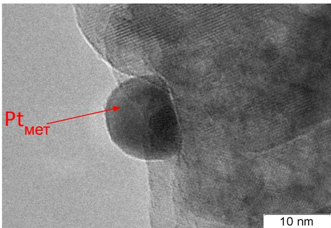
Крупные частицы металлической Pt отвечают за гидрирование предшественников кокса и предотвращают дезактивацию катализатора
