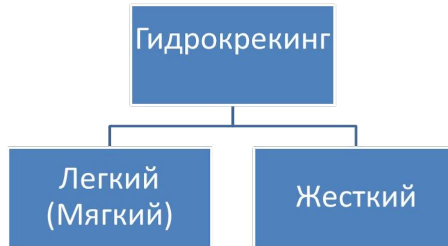
В зависимости от степени конверсии сырья различают легкий (мягкий) и жесткий гидрокрекинг. Целевыми продуктами жесткого гидрокрекинга являются бензиновая и дизельные фракции. При проведении легкого гидрокрекинга выход бензиновой и дизельной фракции ниже и как целевой продукт вырабатывается также гидроочищенная фракция 350-500°С - сырье каталитического крекинга.
