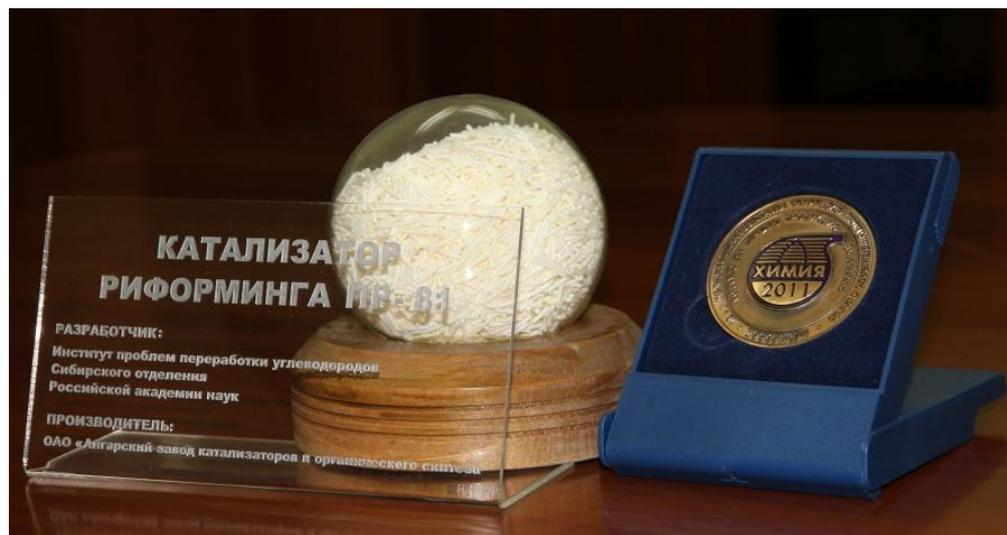
**Катализатор марки А** предназначен для установок риформинга с неподвижным слоем и периодической регенерацией катализатора
