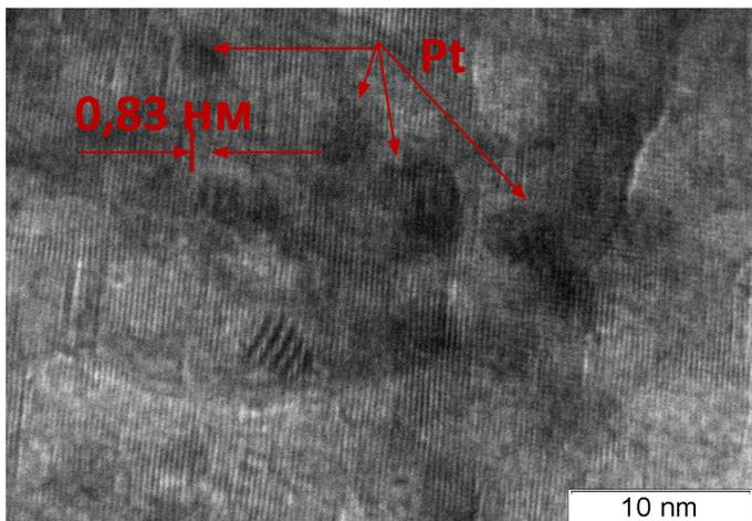
Методом ПЭМ установлено бидисперсное распределение частиц Pt
