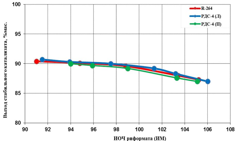
РДС-4 обеспечивает ИОЧ = 100-105, выход  $C_{5+}$  = 87,5-89,5 мас.%;  $H_2$  = 3,6-3,8 мас.%
