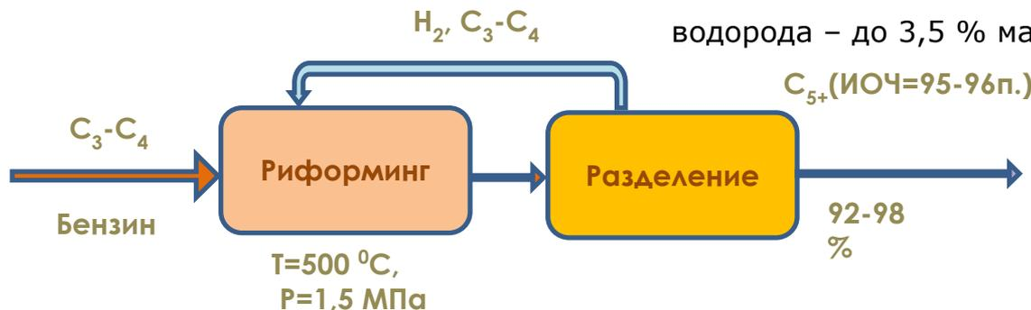
Устойчивая возможность производства высокооктановых бензинов (ИОЧ 96-99 п.) с выходом **бензина до 96 % масс.** (в расчете на жидкое сырье).
