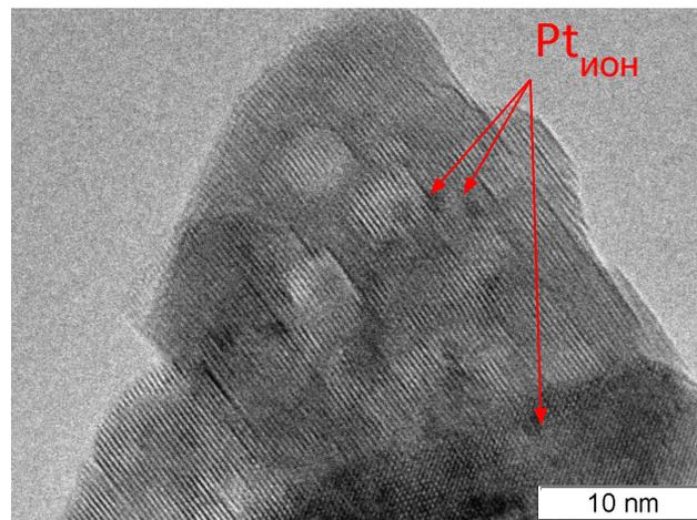
Мелкие частицы «ионной» Pt обуславливают гетеролитическую диссоциацию H<sub>2</sub> с гидридным H<sup>-</sup> переносом на завершающей стадии изомеризации, а также отвечают за регенерацию кислотных H<sup>+</sup> центров
