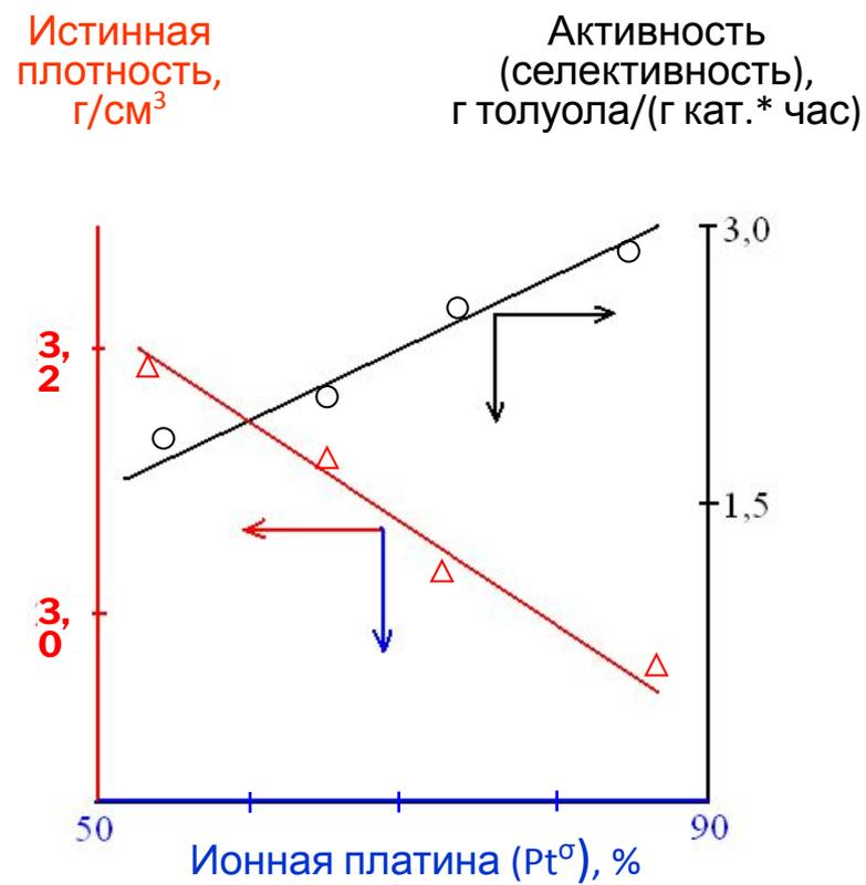
Формирование дефектов на поверхности кристаллов  $Al_2O_3$  обуславливает увеличение доли  $Pt^0$ , а также активности и селективности реакций дегидроциклизации алканов.
