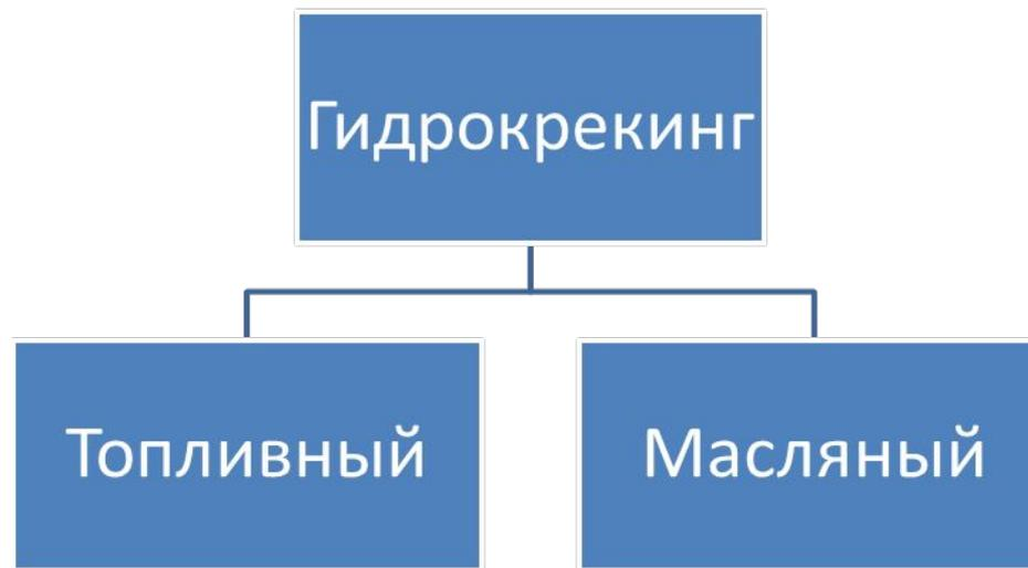
В зависимости от целевого назначения различают топливный и масляный гидрокрекинг. Установки топливного гидрокрекинга НПЗ Европы и АТР настроены на производство дизельного и реактивного топлива, НПЗ США - на максимальный выход бензина.
