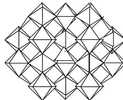
Структура аморфного діоксиду цирконію вигляд перпендикулярний площині розташування атомів цирконію
