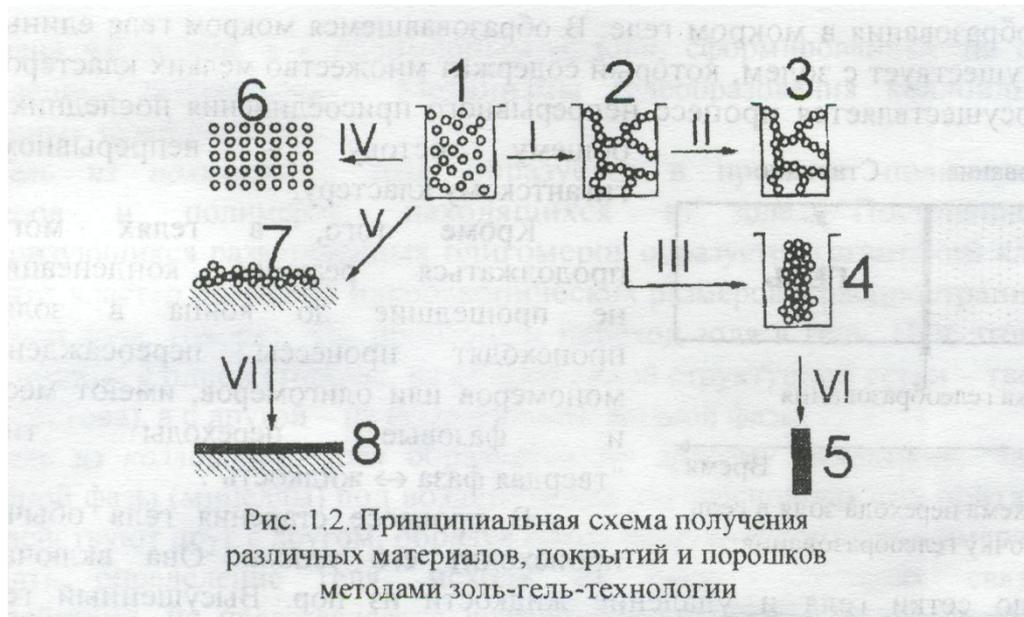
Рис. 1.2. Принципиальная схема получения различных материалов, покрытий и порошков методами золь-гель-технологии
