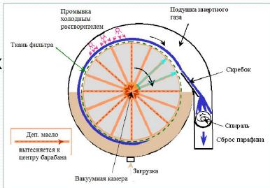
□ <u>GTL</u> – гидрокаталитический процесс получения парафина из газа
