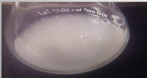
Однако очень разбавленные и очень концентрированные растворы  $\text{HNO}_3$  и  $\text{H}_2\text{SO}_4$  на  $\text{Al}$  практически не действуют – происходит пассивация. В умеренной концентрации растворов этих кислот  $\text{Al}$  растворяется.
